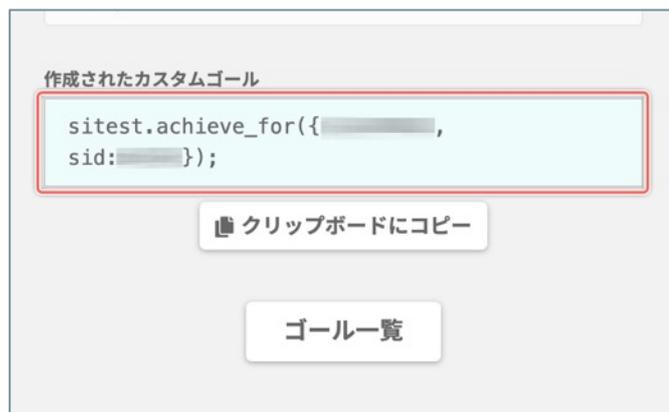
作成された JavaScript のコード（＝「カスタムゴールのコード」）を設置する場合は、手動で「コピー」するか [クリップボードにコピー] ボタンをクリックして、「ゴール」を計測したいトラッキング中のページのソースコード上で **イベントを実行したい位置** に設置します。
